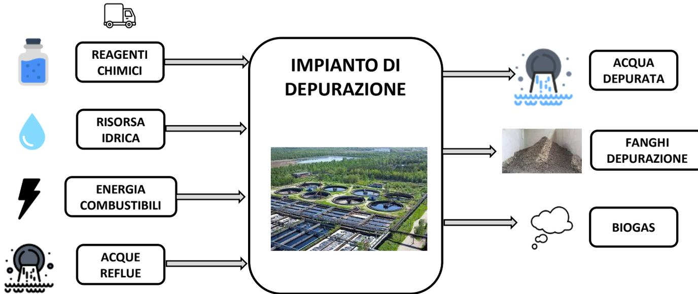
Analisi dal momento in cui si genera il refluo, passando attraverso i processi di trattamento fino a quando il materiale diventa un'emissione in ambiente, un materiale inerte oppure un prodotto utile attraverso un processo di recupero
