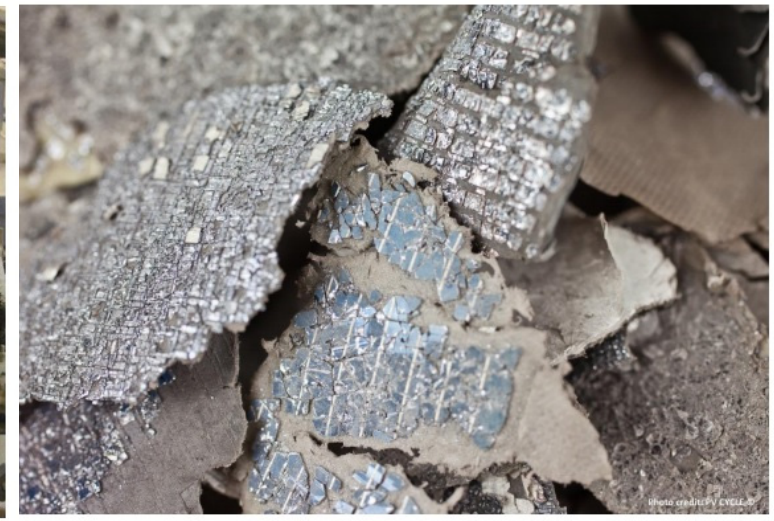
Figura 4 - Separazione dei materiali dopo la frantumazione meccanica [PV CYCLE]. figura 7 - Celle fotovoltaiche in Silicio distrutte con frantumatrici industriali [PV CYCLE].
