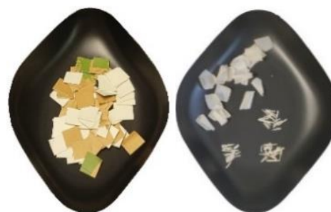
Pezzi di vaschetta in carta con film in PLA sottoposti a digestione anaerobica (sinistra) e residui non digeriti (destra).
