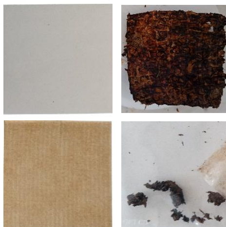
Pezzi di vaschetta in carta con trattamento barriera (sopra) e sola carta (sotto) introdotti nel compostaggio (sinistra) e dopo un mese di trattamento (destra).
